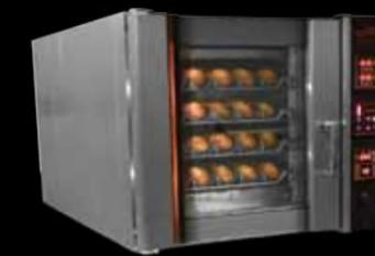
Печь Снакки на 4 противня форматом 400x800мм включает в себя 3 комбинируемых режима выпекания: 1. Выпекание с грилем (с целью придания хрустящей корочки, например, сырной). 2. Конвекционное выпекание (равномерное выпекание для слоеной выпечки). 3. Выпекание на каменном поду идеально для хлебных изделий или пиццы.
