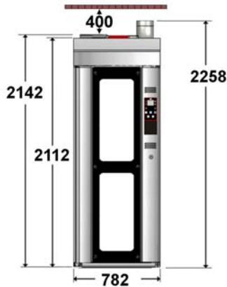
Ferrage de porte à gauche
