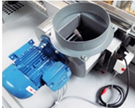
L'évacuation des surplus des vapeurs de cuisson et des condensats de buée s'effectuent sans effort grâce à un **oura électromécanique**, son déclenchement lié à la minuterie est 100 % réglable et programmable
