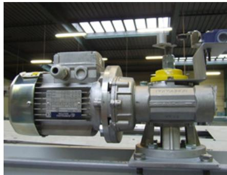
Le **système d'entraînement** de la plateforme est géré par motorréducteur, placé en toiture avec renfort. Ce motorréducteur est largement dimensionné pouvant entraîner une charge maximum de 300 kg. Très facile d'accès, il possède également une sécurité de déblocage de chariot.
